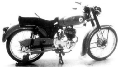
Cualquier detalle es cultivado por Pere Tarragó. En la OSSA 150 el cubrecadenas es de tres piezas, al igual que en el original.
